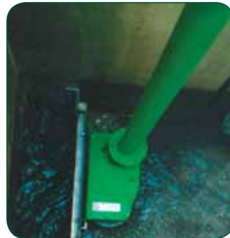
Channel Monster mit verlängerter Motorwelle.
